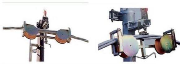
FIGURA 8 – Roldanas múltiplas por estruturas passantes (suspensão)
