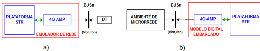
FIGURA 4 – Aplicações dos amplificadores 4Q na infraestrutura laboratorial proposta
