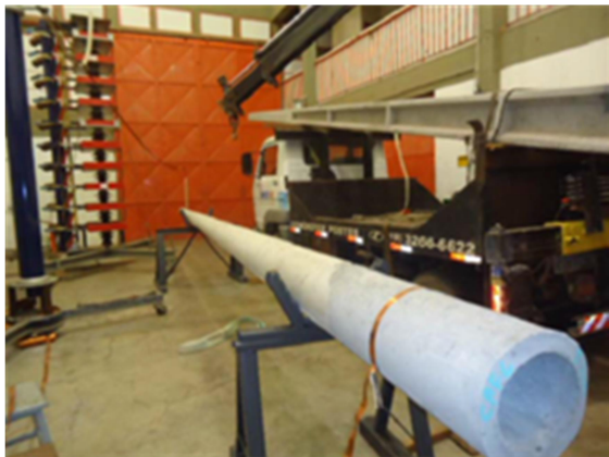
Figura 9 - Ensaio de impulso atmosférico em poste autoaterrado
