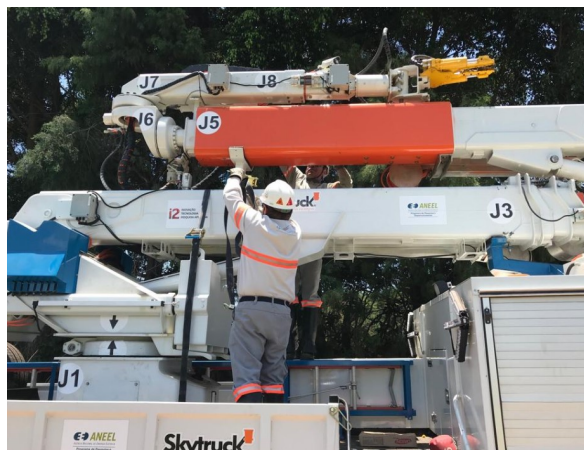
FIGURA 10 – Adesivos adicionados para facilitar a memorização e visualização de cada junta de movimentação
