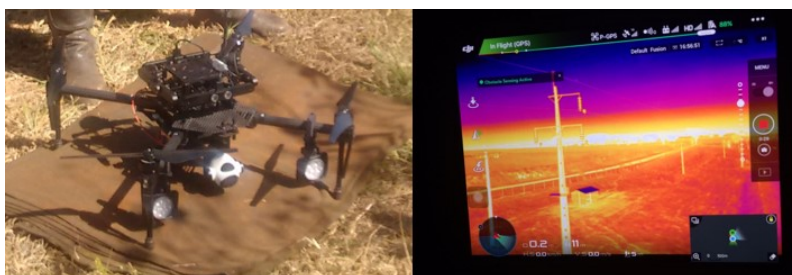
FIGURA 7 – Drone com lanternas e Imagem térmica noturna
