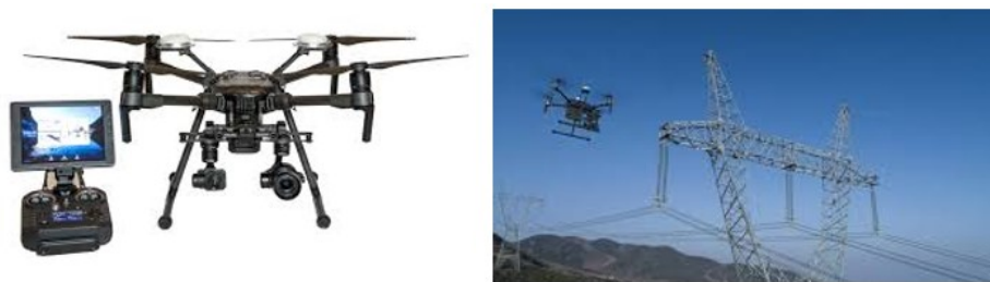
FIGURA 8 – Drone homologado na Elektro e imagem durante a inspeção
