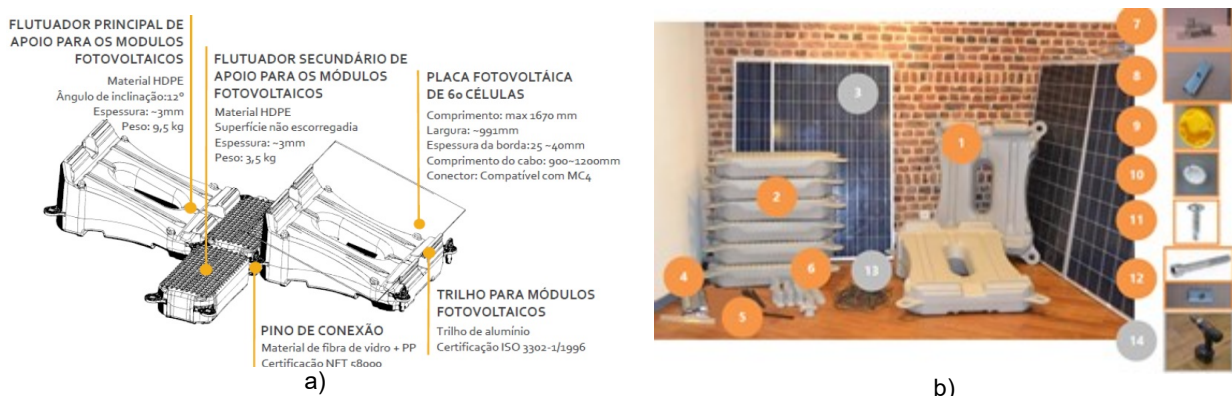
FIGURA 6 – a) Visão esquemática da tecnologia flutuante Hydrelío®. b) Principais componentes do sistema Hydrelío®.
