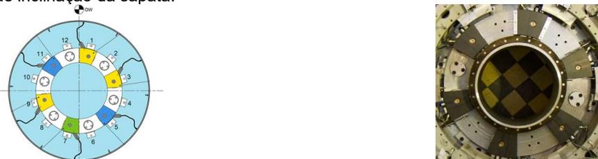
Fig. 5. Sapatas do mancal de escora instaladas
