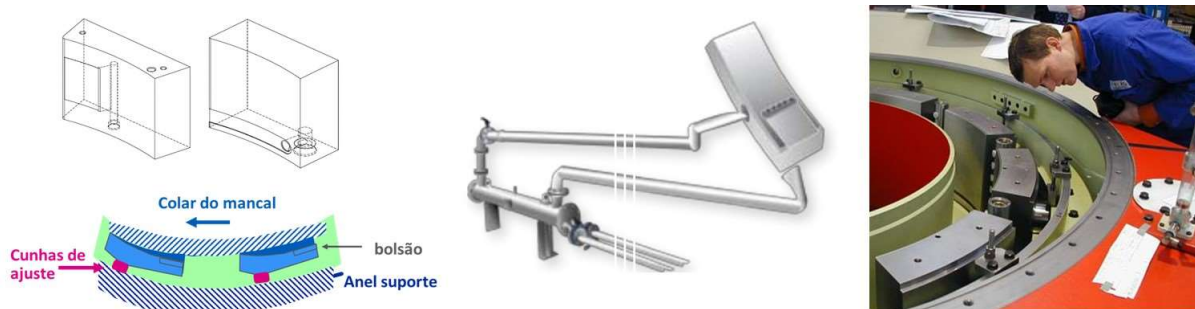
Figura 6 – Conceito de mancal de guia com sistema autopumping embarcado
