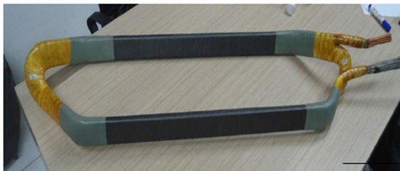
FIGURA 2 – Bobina da barra de estator modelada
