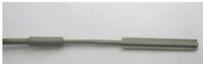
FIGURA 1 – Extensômetro resistivo encapsulado modelo KHCM-10-120-G15-11-C2MV, da japonesa KYOWA INSTRUMENTS
