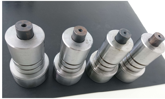
FIGURA 3 – Vista do elemento bombeante da unidade injetora controlada eletronicamente em fase de manufatura
