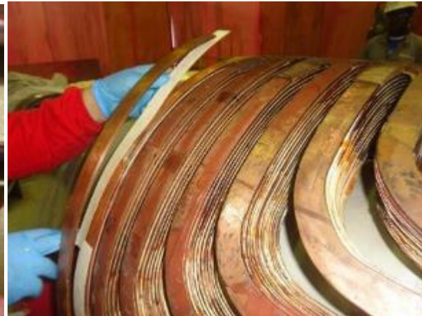
FIGURA 16 – Novas espiras e novas isolações
