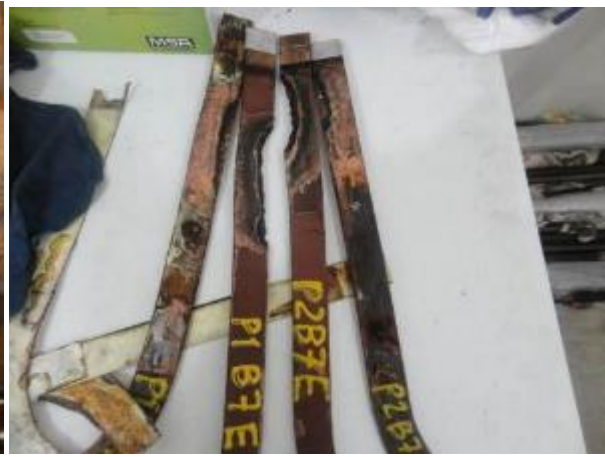
FIGURA 12 – Espiras danificadas e eliminadas
