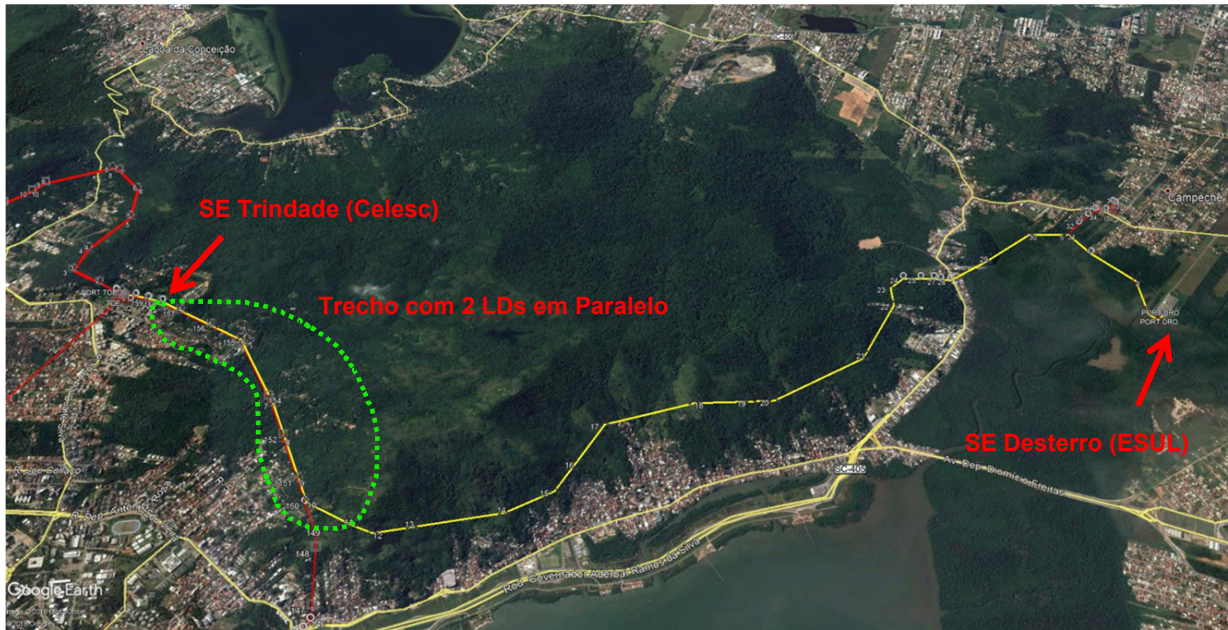
FIGURA 5 – Traçado da LD 138 kV Trindade – Desterro
