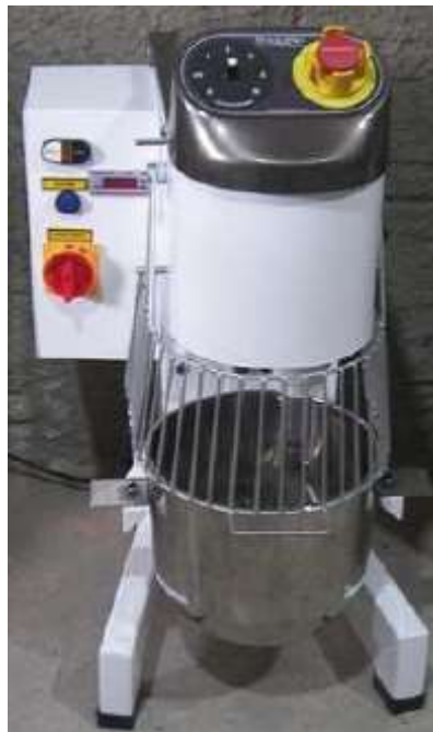
FIGURA 6 – Misturador de argamassa de laboratório
