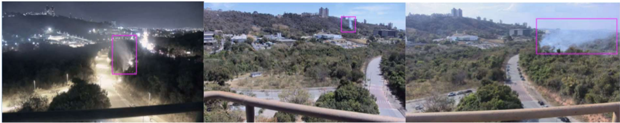
Figura 6 – (esquerda) Detecção de fumaça em uma ocorrência real no Parque Tecnológico de Belo Horizonte (BH-Tec). Além do ambiente noturno como adversidade, é possível observar também diversos reflexos de luzes artificiais, um dos principais responsáveis por falsos alarmes durante o monitoramento. (centro) Detecção de fumaça em uma ocorrência real próxima à Usiminas com vista do prédio institucional do BH-Tec. Nota-se que o foco identificado está longe e ainda em estágio inicial. (Direita) Detecção de fumaça em uma ocorrência simulada no BH-Tec. Nessa situação, a fumaça já foi dissipada pelo vento e parte dela é camuflada no céu.
