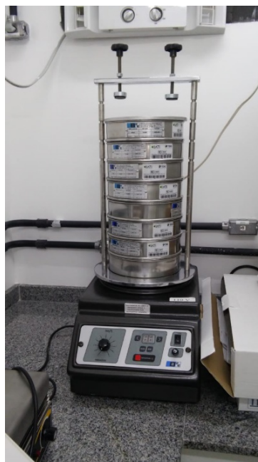
FIGURA 5. Mesa vibratória utilizada para análises granulométricas do solo coletado na Usina tubarão.
