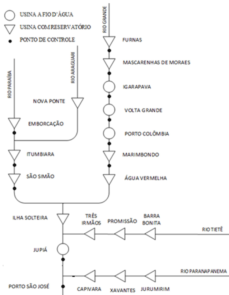
FIGURA 1 – Esquema topológico da bacia do rio Paraná até o posto fluviométrico de Porto São José. Fonte: CHAN et al. (2017)
