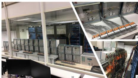
FIGURA 2 – (a) Bancada dos TSTR no LASSE/FPTI-BR, (b) detalhe das gigas de teste das unidades de vão e central, além da (c) conexão do sistema SIEMENS<sup>®</sup> SIPROTEC 4 7SS52 aos amplificadores da ferramenta RTDS<sup>®</sup>.
