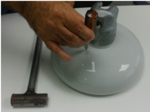
FIGURA 7 – Posição para quebra do isolador com RTV
