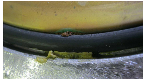
FIGURA 9 - Para-raios de 138 kV - Inspeção no Fabricante - Ponto de penetração de umidade: vedação superior - Colagem do ANEL ORING de borracha nitrílica com cola epóxi no diafragma
