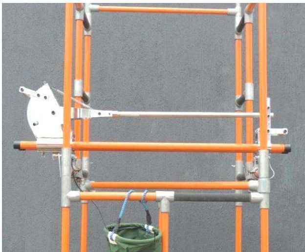
FIGURA 9 – Instalação na horizontal dentro do andaime isolante
