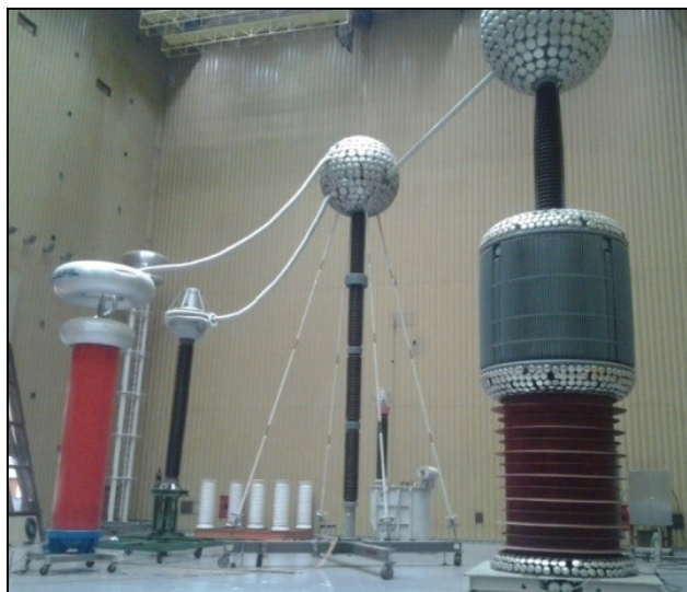
Figura 4 – Arranjo do circuito de ensaio de DP, tensão suportável a 60 Hz e medição de capacitância e fator de perdas dielétricas no Laboratório de Alta Tensão do Cepel
