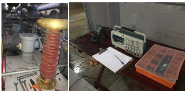
Figura 2 – Medição da tensão induzida na barra A
