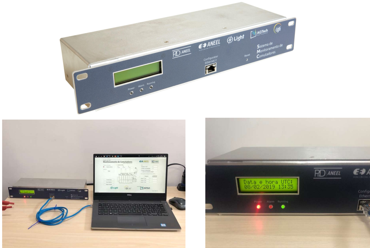
FIGURA 1. Sistema de monitoramento de comutadores.
