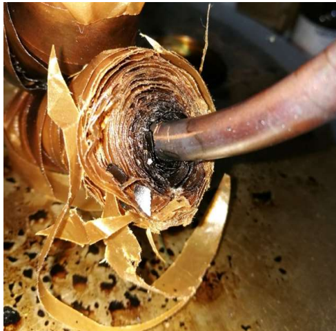
Figura 4 – Aspecto do papel, enrolado à resistência, ao término do primeiro ensaio e GP do papel das camadas 32 a 4
