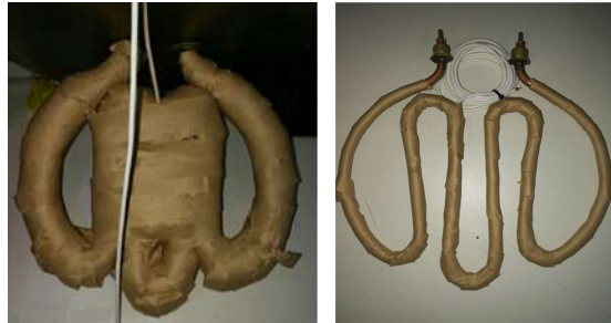
Figura 2 – Papel enrolado à resistência e termopar no primeiro e segundo ensaio, compondo 32 e 12 voltas, respectivamente
