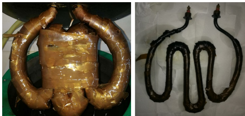
Figura 3 – Aspecto do papel, enrolado à resistência, ao término do primeiro e segundo ensaios, respectivamente
