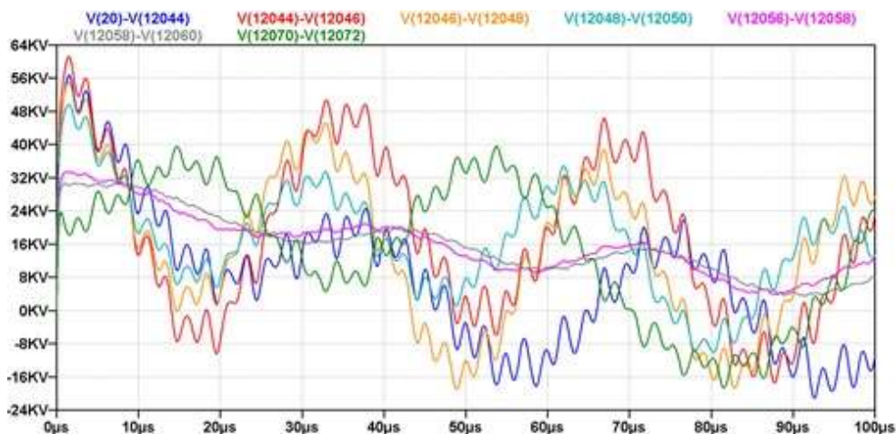
FIGURA 9 – Tensões entre discos no enrolamento de AT
